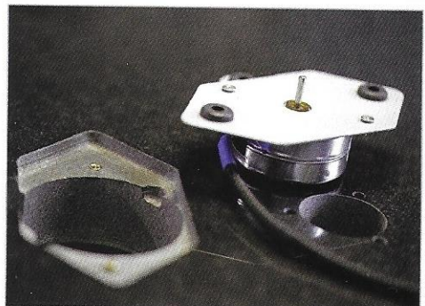
Moteur d'entraînement synchro et son emplacement taillé dans le granit.
