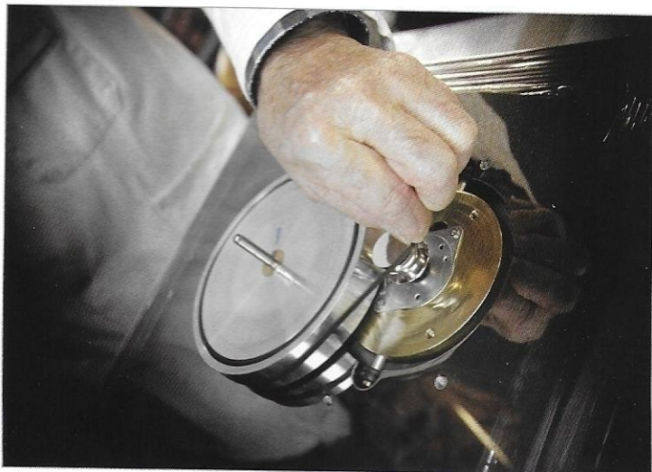
Procédure manuelle de changement de vitesse de rotation - 45 ou 33 tours/minute.
